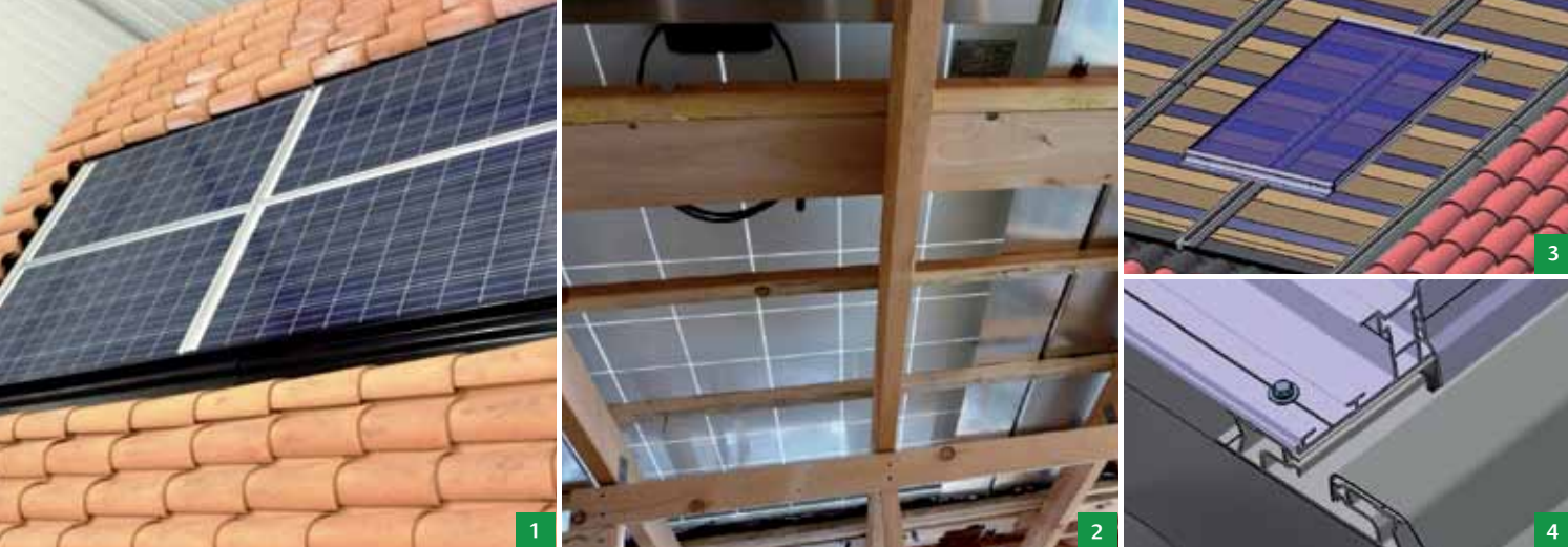
1. Système KlipRoof 011 intégré au toit. 2. Charpente vue de l'intérieur. 3. Positionnement du module dans les gouttières. 4. Fixation du module sur les gouttières.
