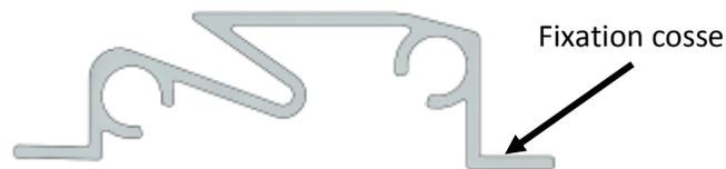
Pour finir, il est également nécessaire de connecter les rails porteurs entre eux, puis les relier à la terre afin d'assurer la protection de l'installation contre les surtensions d'origine atmosphérique ou dues à des manœuvres.
