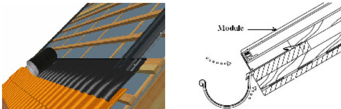
Figure 98: Schémas sur l'étanchéité en bas d'installation PV (notice de montage des systèmes "Sol Montagesysteme25i" de S.E.N et Energyroof)
