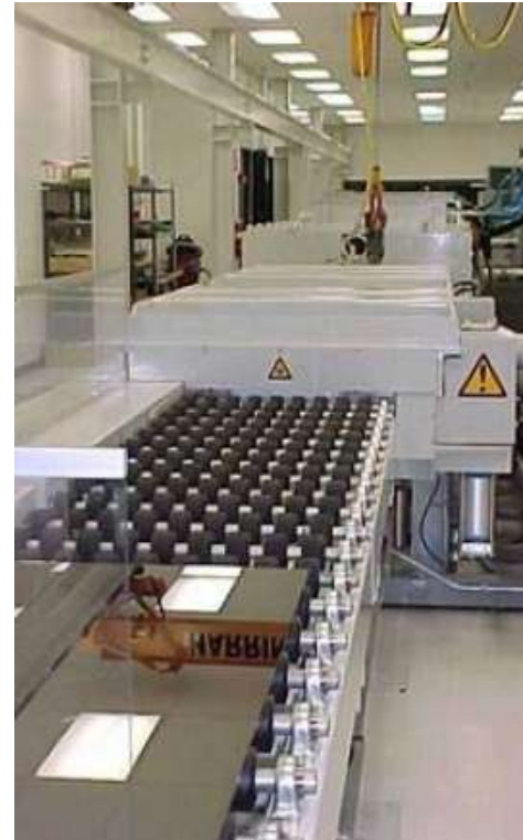
Ligne de production pilote Shell Solar (largeur 60 cm)
